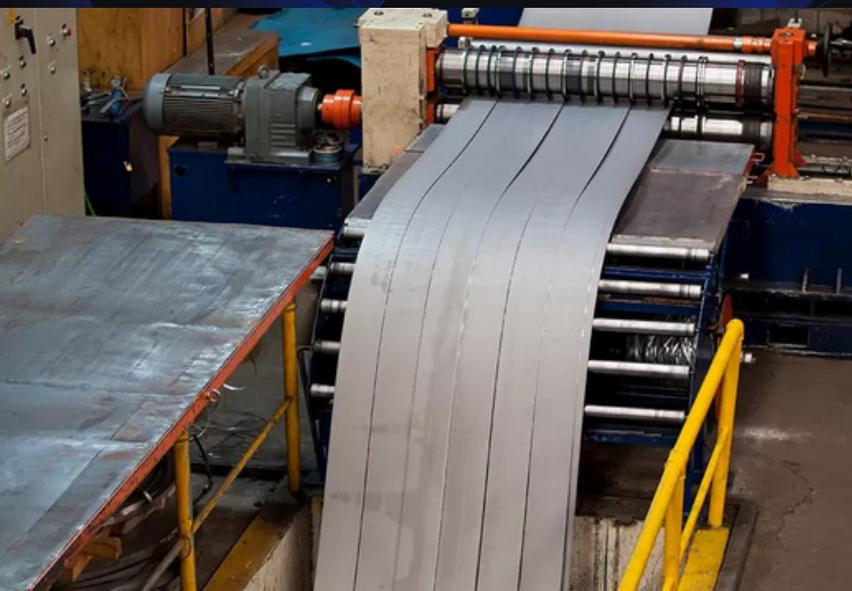
**Contamos con maquinaria de corte longitudinal denominada SLITTER con la cual se realizan cortes de fleje.**
